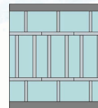
汉代建筑墙面的灯笼形分隔条
