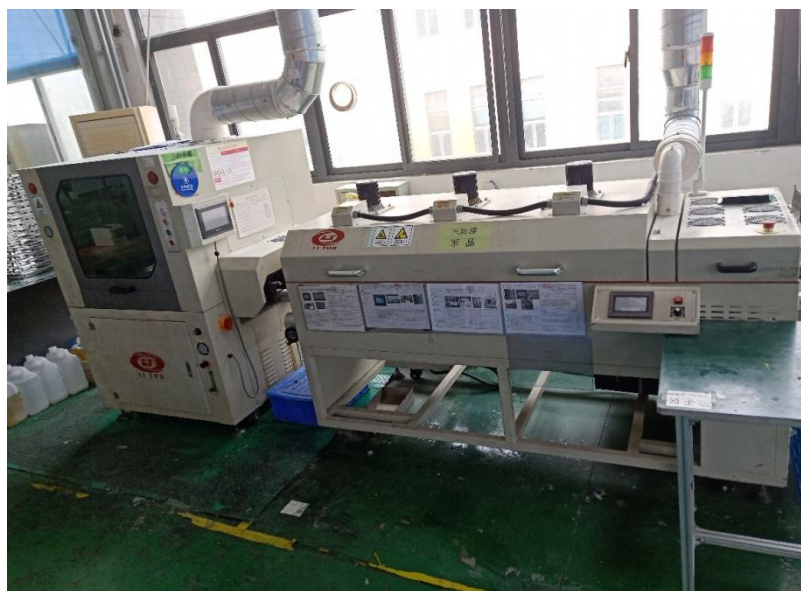
图 2-4 三防涂覆固化设备
